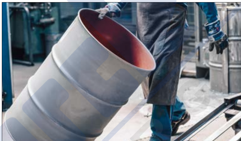
Der Lack ist ab. Das Entfernen des Außenlacks ist ein Prozessschritt bei der Stahlfassrekonditionierung.
